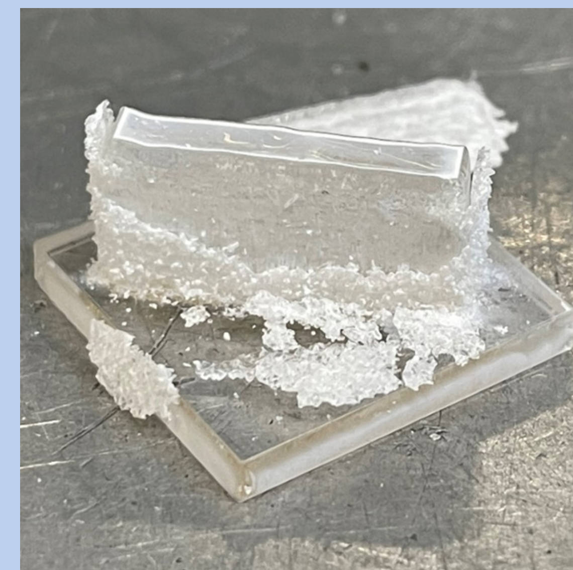
Gelöster Pulverpartikelrand einer gerade aufgebauten Probe
