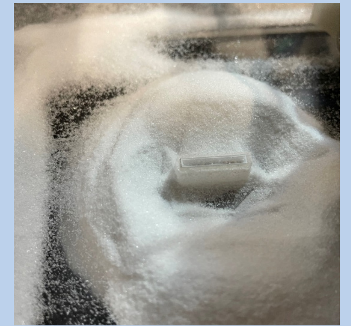
Probe im Pulverbett nach dem Bauprozess
